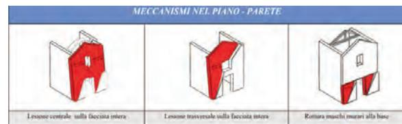
Fig. 1b – Meccanismi nel piano.
