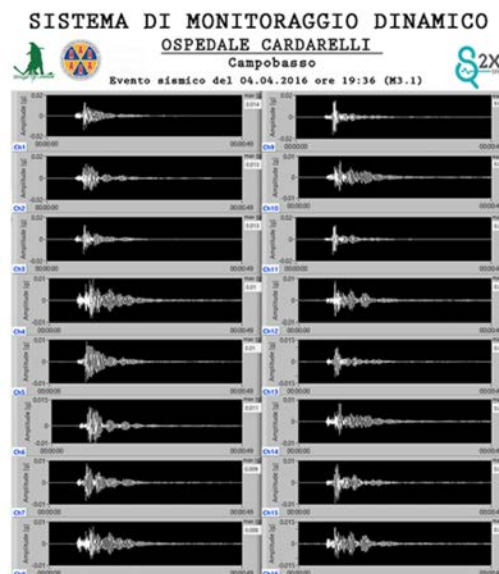
Terremoto di Magnitudo 3.1 registrato dal sistema di monitoraggio strutturale installato presso l'Ospedale Cardarelli di Campobasso. Accelerazione massima longitudinale 0.014 g Accelerazione massima trasversale 0.013 g
